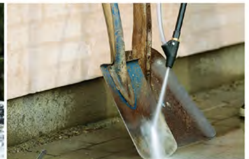
Water Sandblasting set برای کندن زنگ زدگی، رنگ و غیره از اجسام سخت
